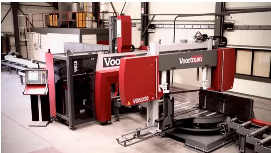
Figura 2.2: Célula de corte e furação da Voortman
