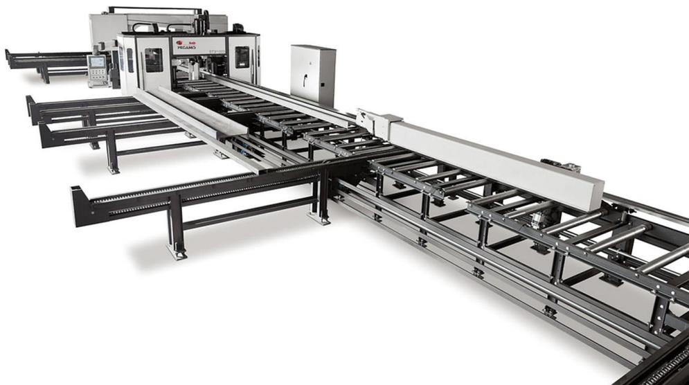
Figura 1.2: Célula de corte e furação de vigas
