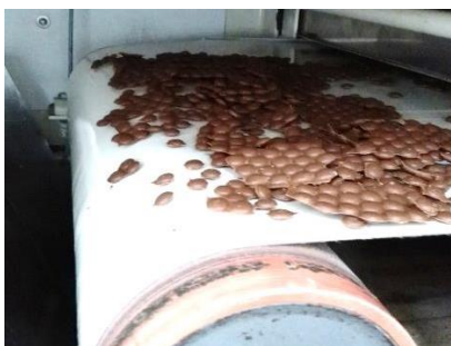
Figura 37: Massa de chocolate moldada à entrada da peneira
