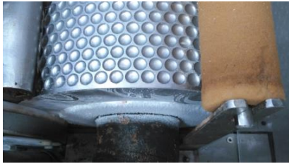
Figura 35: Rolos de moldação com gelo
