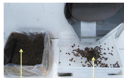
Figura 38: Centros de chocolate à saída da moldadora, com e sem defeitos
