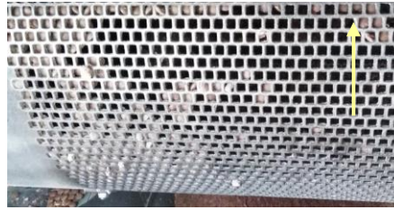
Figura 61: Centros de chocolate incrustados na rede metálica do tambor
