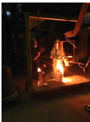
Figura 139: Aplicação de ISOPULVER na bacia de vazamento.
