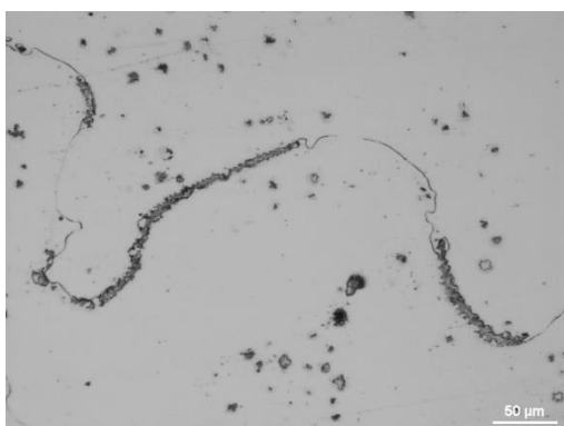
Figura 207: Fronteira de grão observada na peça do fêmur C6_22 depois do tratamento térmico 3, zona 3 (MO 160X).
