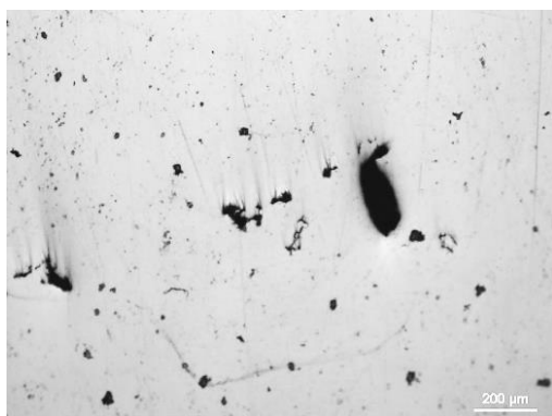
Figura 68: Defeito superficial 1 observado na peça F3 (MO 40X).
