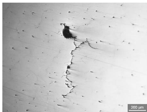
Figura 69: Defeito superficial 2 observado na peça F3 (MO 40X).
