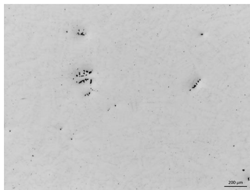
Figura 157: Microrechupes encontrados na peça C9_33, cacho nº 9 tíbia, na zona 4 (MO 30X).
