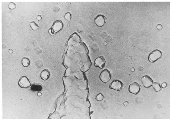
Figura 22: Material interdendrítico depois de 1h a 1220°C (têmpera em água). Ampliação original do artigo 20 000X (TEM) (Kilner et al. 1982).
