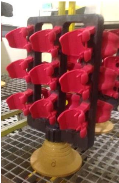
Figura 131: Cachos 6 e 7 – Fémur A3 grossa, peças inclinadas.
