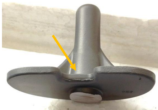
Figura 145: Representação da rebarba na zona 2, resultado de fissuras nas carapaças.
