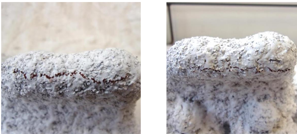
Figura 111: Exemplos de carapaças cerâmicas com fissuras.
