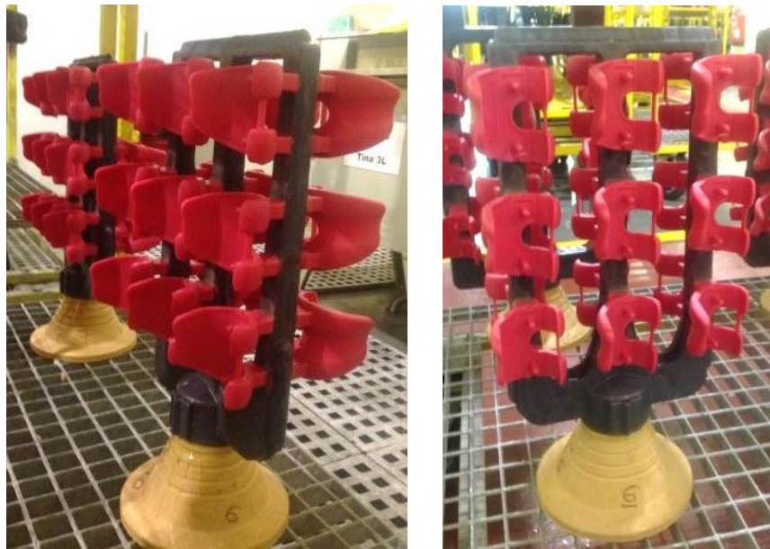
Figura 132: Cacho 6 e 7 – Fémur A3 fina, peças na horizontal.
