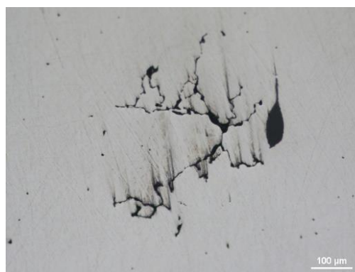
Figura 71: Defeito superficial 2 observado na peça T2 (MO 80X).
