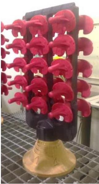
Figura 128: Cachos 1 e 2 – Tíbia A3 fina, para revestir com areia S2.
