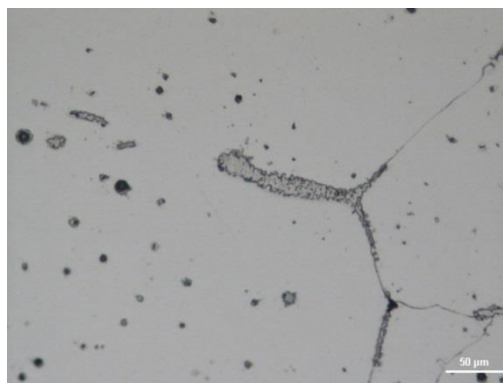
Figura 204: Fronteira de grão com carbonetos com morfologia rendilhada, encontrados na peça C3_33, depois do TT 3 na zona 3, (MO 160X).
