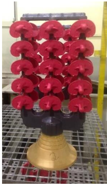
Figura 129: Cachos 3 e 4 – Tíbia A3 grossa, para revestir com areia S2.
