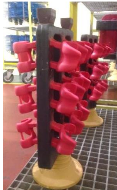
Figura 131: Cachos 6 e 7 – Fémur A3 grossa, peças inclinadas.
