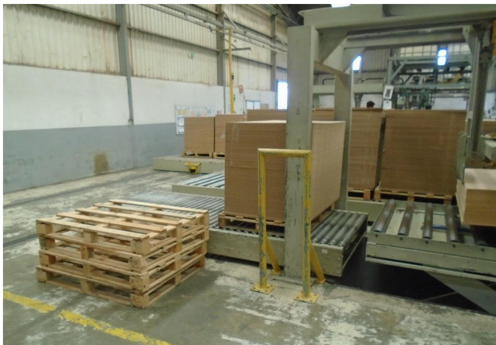
Figura 16- Saída da Calibradora. As paletes são movimentadas nos tapetes de rolos, seja a retirar do armazém para alimentar a Calibradora, seja a armazenar para a etapa seguinte.
