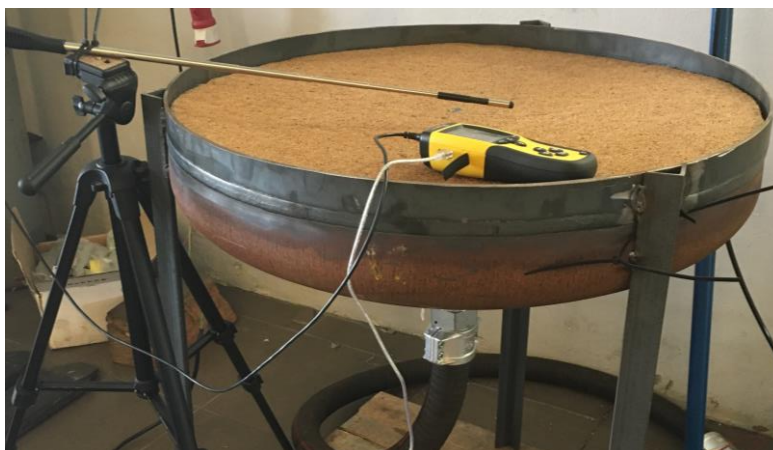
Figura 18 - Fundo copado DN800 utilizado para a realização dos testes experimentais.
