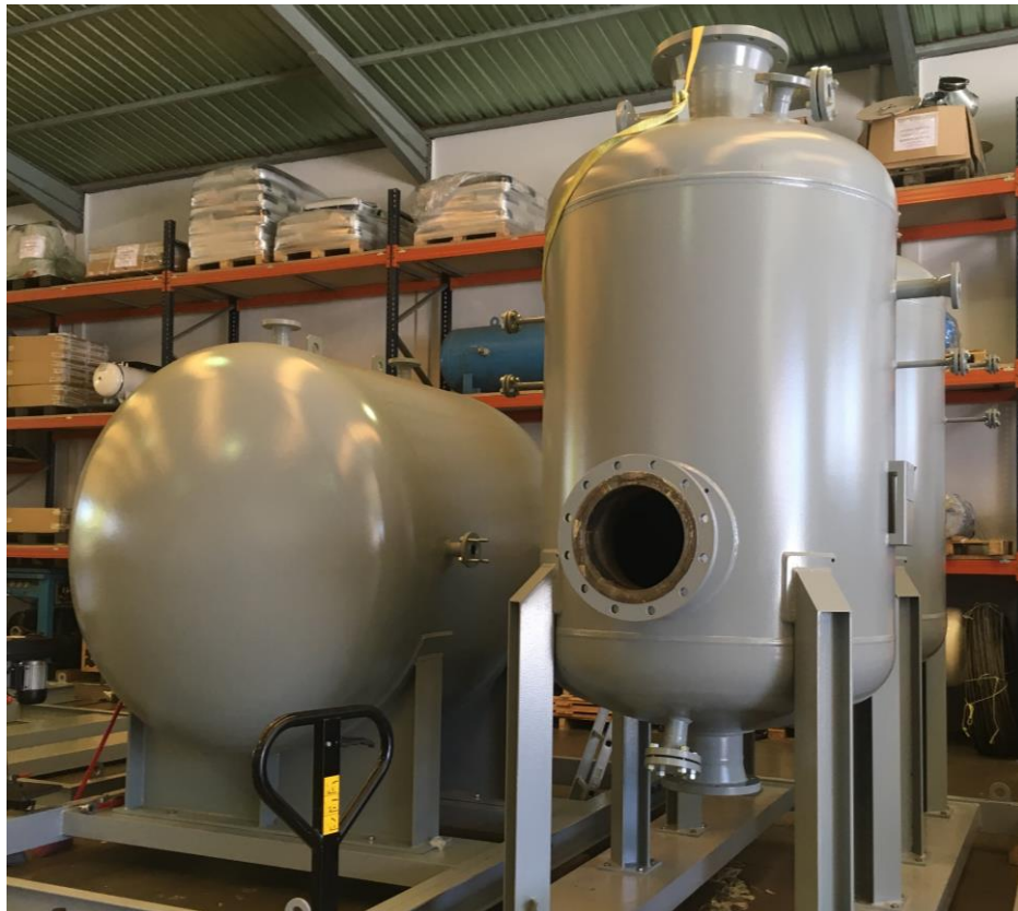
Figura 23 - Unidade de PSA com colunas DN1200 que seria utilizada para realização de testes experimentais.
