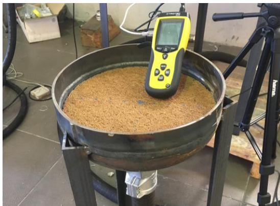
Figura 16 - Fundo copado DN300 utilizado para a realização dos testes experimentais.
