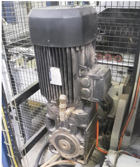
Figura 5.10 – Exemplo de um moto-redutor
