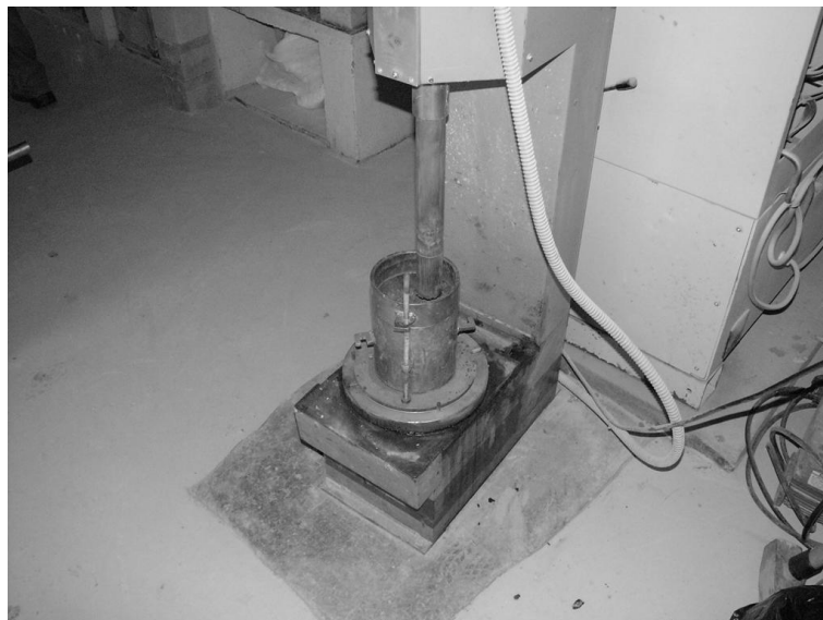
Fig. 4.5 – Momento de aplicação das pancadas no ensaio Proctor
