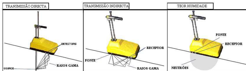
Fig.4.11 - Esquema de funcionamento de um gamadensímetro
