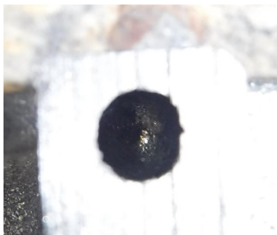
Figura 9 - Defeito de bolha no interior de uma culassa.
