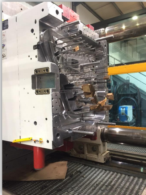
Figura 15 - Inspeção visual do sistema de extração
