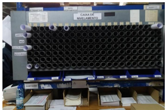
Figura 40 - Caixa de nivelamento sem utilização apropriada
