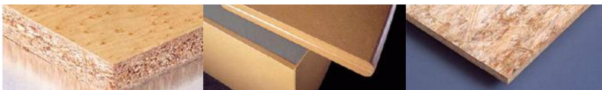
Figura 1 - Imagem representativa dos painéis produzidos pela Sonae Arauco: à esquerda um painel PB, ao centro um painel de MDF e à direita um painel de OSB (Sonae Indústria, 2010).
