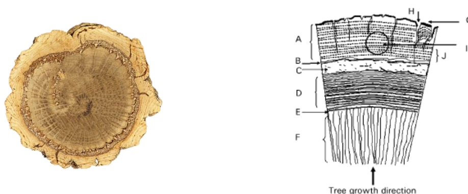
Figura 2 - Secção transversal do sobreiro à esquerda e representação esquemática da secção transversal do sobreiro: (A) cortiça/felema, (B) câmbio subero-felodérmico, (C) felogénio, (D) floema, (E) câmbio cortical (F) madeira/xilema, (G) casca, (H) canais lenticulares, (I) área de produção de rolhas, (J) anéis de crescimento anual. Adaptado de (Silva et al., 2005, Fortes et al., 2004).
