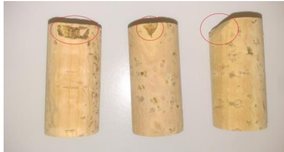
Figura 14 - Rolhas com defeito de repasse.
