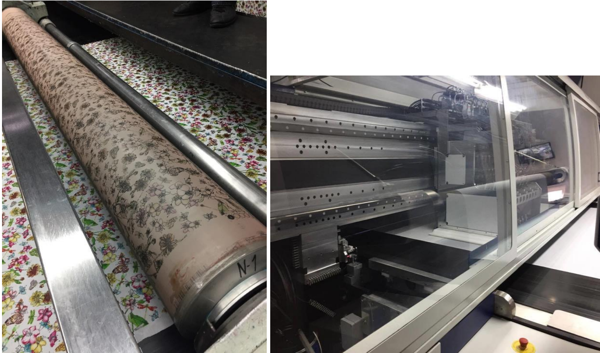
Figura 11 – Processos de estampagem (convencional à esquerda, digital à direita)
