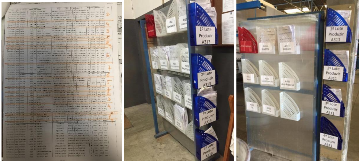
Figura 48 – Lista de planeamento com sequenciamento dos lotes realizada pelo mizusumashi e sequenciadores em diferentes máquinas
