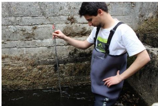
Fig. 42 - Determinação de velocidades em diferentes pontos da bacia com recurso a um micromolinetete
