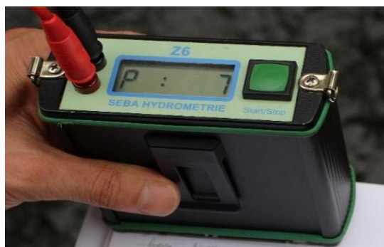
Fig. 43 - Contagem do número de voltas do micromolinetete
