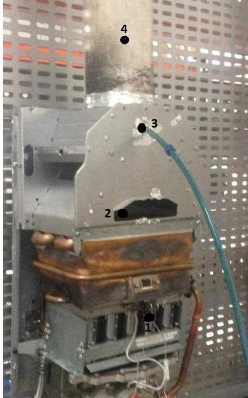
Figura 5.12 - Figura explicativa do cálculo do arrasto de ar.
