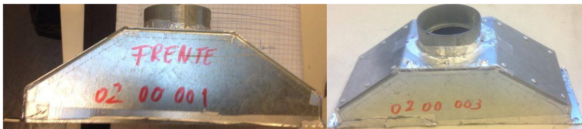
Figura 4.24 - Fotografias da vista frontal e de topo da chaminé em que são visíveis as “rampas”.
