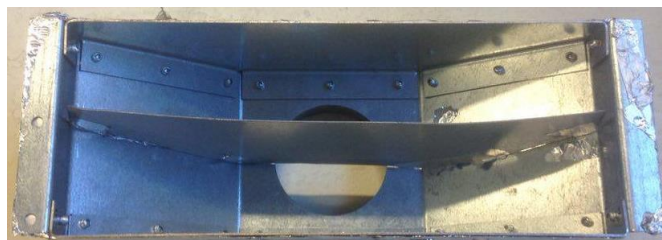
Figura 4.23 - Fotografia do interior do topo da chaminé venturi ao qual foi acrescentada uma divisória.
