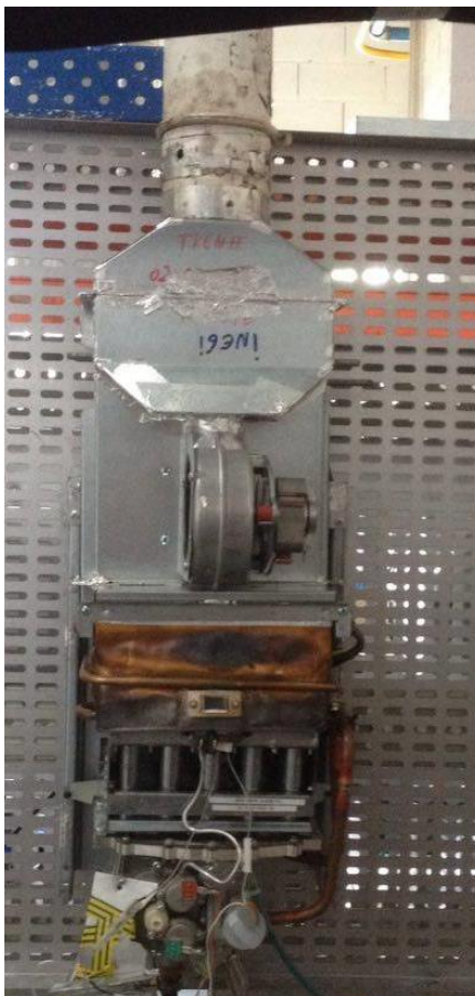
Figura 4.21 - Fotografia da chaminé venturi acoplada ao esquentador.
