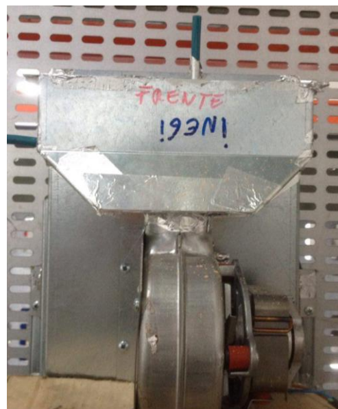
Figura 5.1 - A- Fotografia da instalação de ar comprimido; B- Fotografia do aspeto final do esquentador com a configuração atual; C- Fotografia do tubo de poliuretano colocado no compartimento de insuflação de ar da chaminé.
