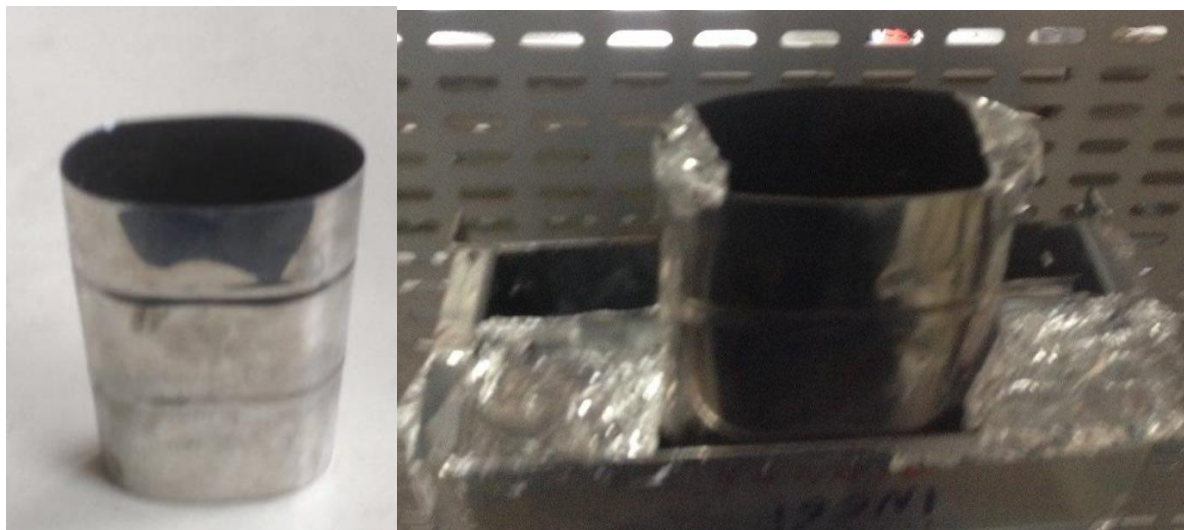
Figura 4.41 - Fotografias, à esquerda o oco tubular e à direita o mesmo montado no compartimento de insuflação de ar da chaminé venturi.
