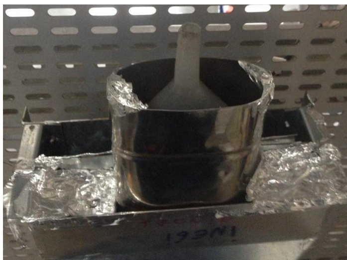
Figura 4.43 - Associação de um funil à saída do oco tubular.
