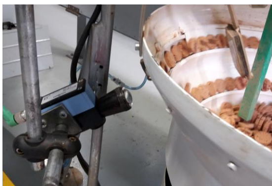
Figura 28- Sensor responsável por escolher a face dos discos (antes)
