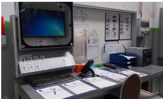
Figura 48-Mesa de apoio às secções da colagem e da retificação após implementação de 5S
