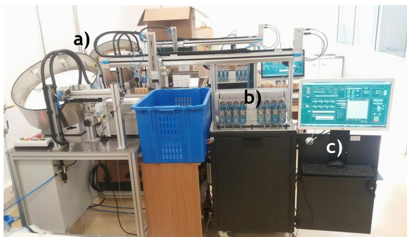
Figura 5 - Equipamento NDtech constituído pelo módulo de alimentação/extração (a), o módulo de incubação (b) e o módulo de análise (c).
