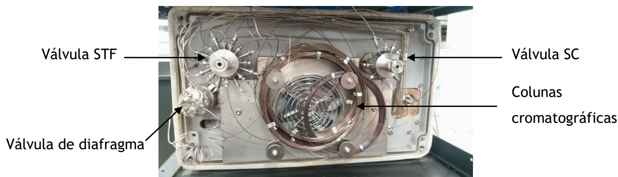
Figura 7 - Forno cromatográfico do equipamento NDtech.
