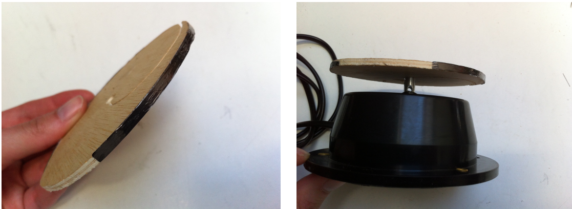
imagem 31: primeiro protótipo desenvolvido durante o projecto para a construção do disco loop
