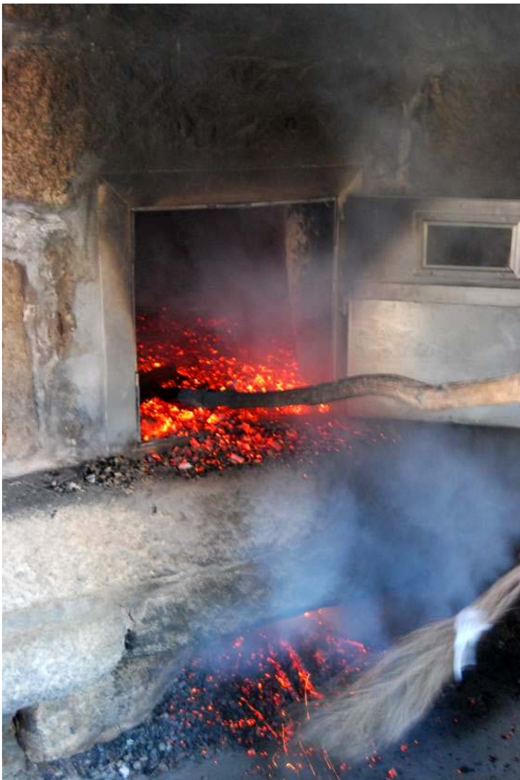
Fig. 84 – Retirar o borralho da fornalha, após conclusão do aquecimento e varrê-lo para a “borralheira” (por baixo da fornalha) com o auxílio de uma giesta que serve de vassoura. Dia de cozedura no forno do Lugar de Portelinha. 2012.
