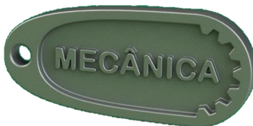
Figura 24 - Vista de trás do porta-chaves do MIEM da versão alterada segundo as regras de traçado para fundição.
