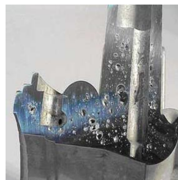
Figura 16 - Peça de fundição injetada com porosidades (Eastern Alloys Inc. 2012).
