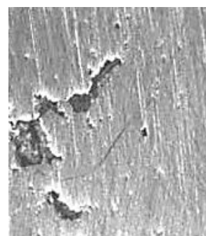
Figura 17 - Exemplo da forma de um rechupe numa peça fundida (Eastern Alloys Inc. 2012).
