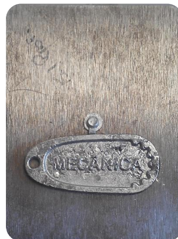
Figura 44 - Porta-chaves do MIEM preso na moldação fixa após injeção.
