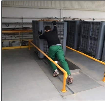
Figura 17: Posição desadequada na movimentação de contentores
