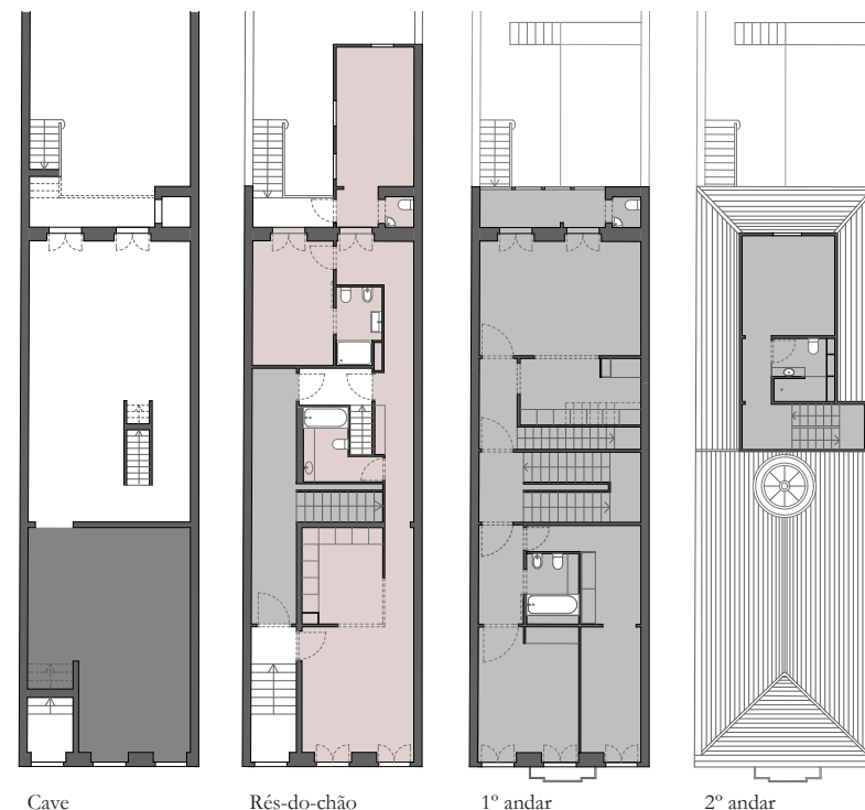
204. Planta adaptada às tipologias T2 e T3, destinando-se a cave a arrumos e áreas comuns. A possibilidade de efectuar um corredor no lugar do patamar das escadas permite que os fogos sejam distribuídos ao longo dos pisos, não sendo necessária nenhuma divisória nas escadas
