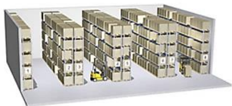
Figura 25. Sistema de racks convencionais (Fonte: Schaefer)
