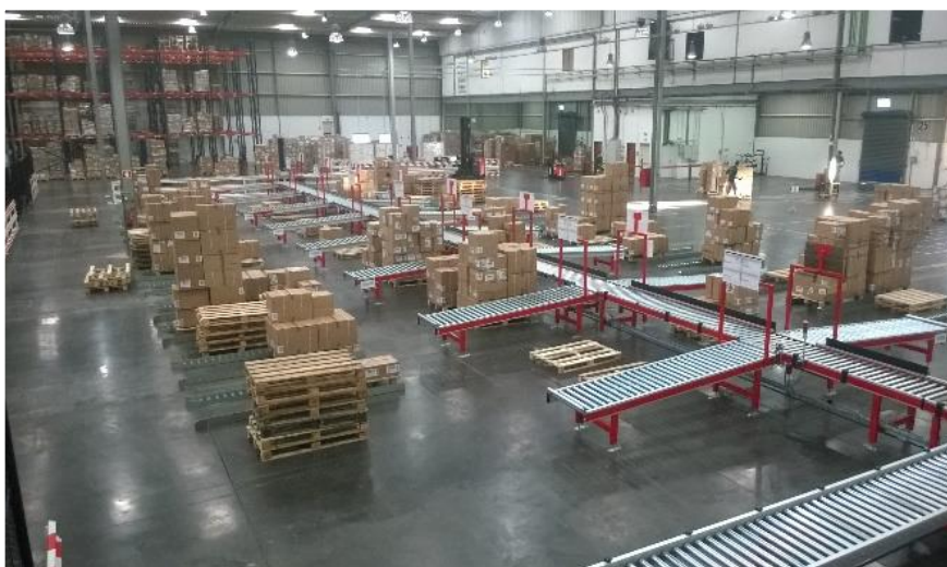
Figura 13. Sorter automático da Expedição
