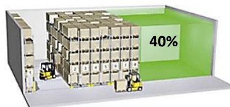
Figura 26. Sistema mobile racking e ganhos de área (Fonte: Schaefer)
