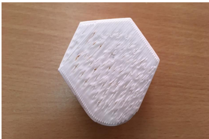
Figura 2.2 – Defeitos na primeira camada depositada numa peça em ABS (impressa na máquina de impressão tridimensional disponível).
