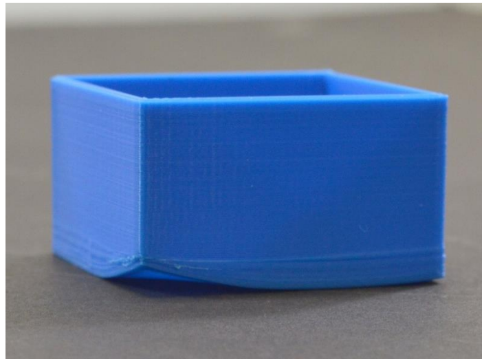
Figura 2.4 – Deformação de origem térmica de peça em ABS [5].
