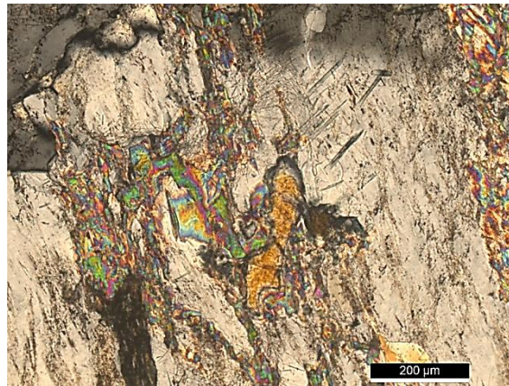
Figura 40 – Destaque para o cristal de andaluzite incluído em microclina. Fotografia tirada em LPX.
