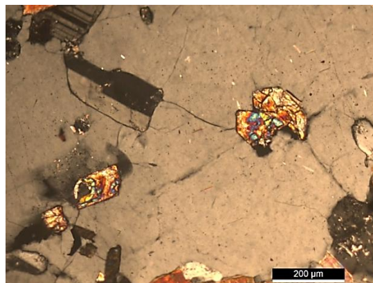
Figura 29 – Cristais prismáticos de alanite inclusos em quartzo. Fotografia tirada em LPX.
