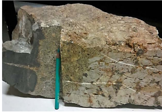
Figura 67 – Amostra de mão da fácies \gamma m_1 . Na figura é possível observar o granito propriamente dito, um enclave melanocrata fracamente granitizado e cumulos de megacristais de feldspato potássico.
