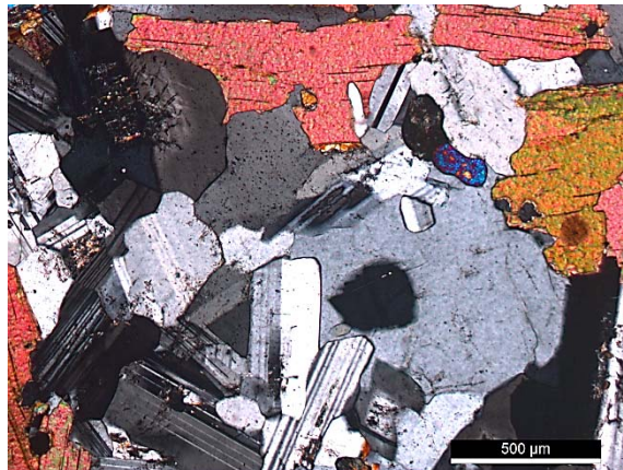
Figura 81 – Fotografia alusiva aos grãos de quartzo na fácies \gamma\Delta_3 . Tirada em LPX.
