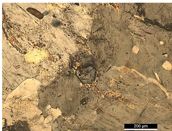
Figura 38 – Inclusão hexagonal de apatite em microclina. Fotografia tirada em LPX.
