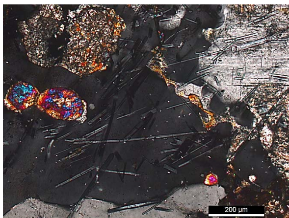
Figura 82 – Grãos prismáticos de apatite no seio de quartzo, e alanite. Fotografia tirada em LPX.
