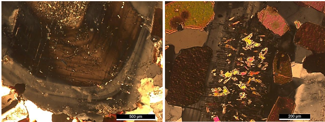
Figura 43 – Zonamento (à esquerda). Inclusões na plagioclase (à direita). Fotografias tiradas em LPX.
