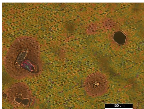
Figura 48 – Inclusões prismáticas de apatite, zircão e monazite em biotite. Fotografia tirada em LPX.
