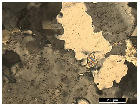
Figura 34 – Quartzo com contactos ondulados junto a microclina. Fotografia tirada em LPX.
