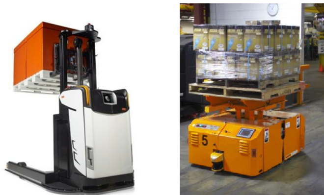
Figura 2.14: Esquerda: AGV empilhador. Direita: AGV de carga única.
