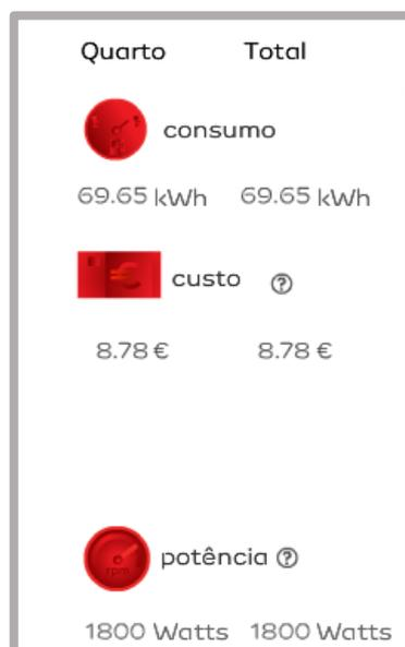
Figura 4.11 - Custo mensal de uma unidade de ar-condicionado de 1800W (Fonte: EDP)
