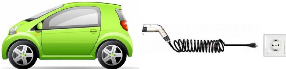
Figura 6.2 – Exemplo de modo de carga 1 (Adaptado de Fonte: MOBI.E)
