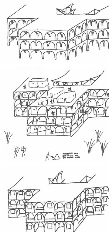
Fig.18. O processo de autoconstrução pensado por Yona Friedman para Belapur, Índia [1980], na suas várias fases. Primeiro a estrutura básica de tijolo, depois cada família constrói a sua habitação com os materiais a que tem acesso localmente, podendo melhorá-la conforme lhe for sendo economicamente possível.
