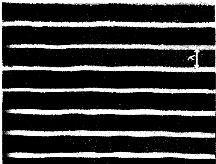
Figura 2.2 - Ondas periódicas rectilíneas obtidas numa tina de ondas. As superfícies de onda são linhas rectas.
