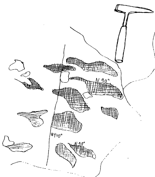
Figura IV.4 – Cristais de feldspato em forma de sigmóide, com a direcção de deformação segundo N90° vertical, medidos num plano horizontal.
