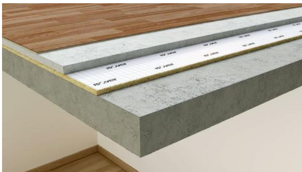
Fig. 2.49 – Esquema de uma laje interior com isolamento sonoro na face superior [44]
