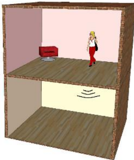
Fig. 2.40 – Esquema ilustrativo de um ruído de percussão
