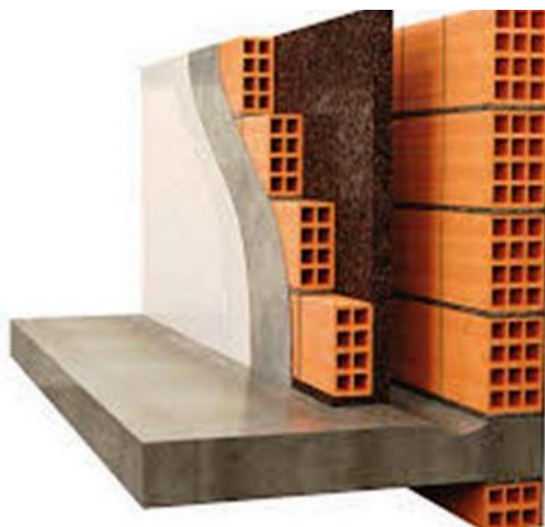
Fig. 2.44 – Parede interior dupla com caixa-de-ar e painel de cortiça [42]
