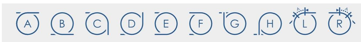
Figura 2-4 – Conjunto de esquemas exemplificativos de algumas configurações de transportadores em espiral existentes no mercado.
