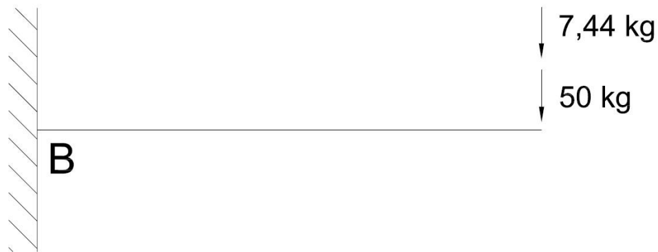
Figura 4-6 – Esquema do carregamento considerado para o cálculo à flexão dos braços horizontais.
