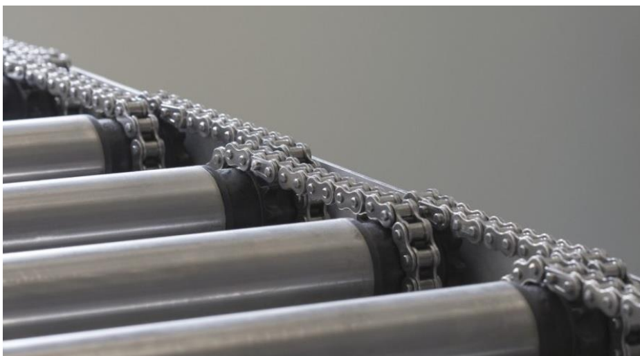
Figura 2-1 – Imagem de detalhe de um transportador de rolos, evidenciando o seu método de acionamento [1].
