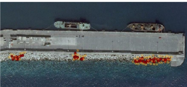
Figura 14. Medição in loco da variação das componentes x, y e z dos deslocamentos na superestrutura durante uma manobra real de atracação e monitorização de deslocamentos em tetrápodes.
