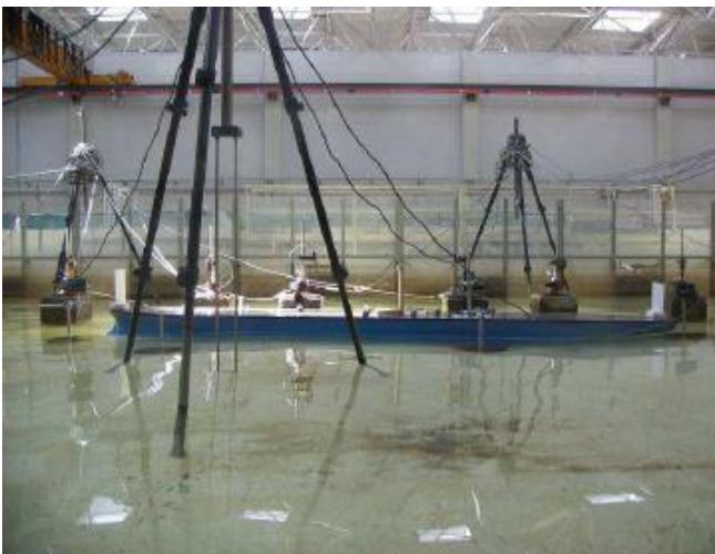
Figura 9. Modelo dos quebramares norte e sul do porto de Leixões, pormenores da cabeça do quebramar norte, modelo de um petroleiro amarrado ao posto A do quebramar norte e equipamentos de medição (FEUP).
