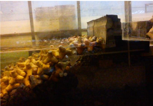
Figura 13. Manto em tetrápodes do quebramar do Funchal e correspondente modelo físico (FEUP).
