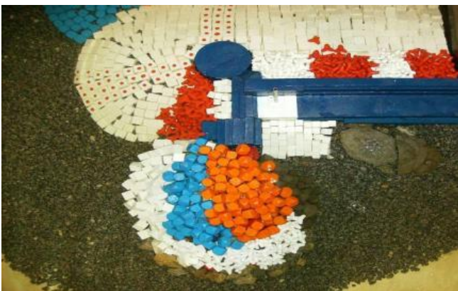
Figura 10. Ensaios em laboratório do comportamento de sistemas de confinamento de areias com geossintéticos. Dinâmica de fundos móveis na presença de geocontores e de geocilindros (FEUP).
