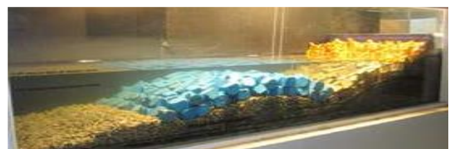
Figura 11. Modelo do quebramar norte do porto de Leixões com o quebramar submerso adjacente (FEUP).
