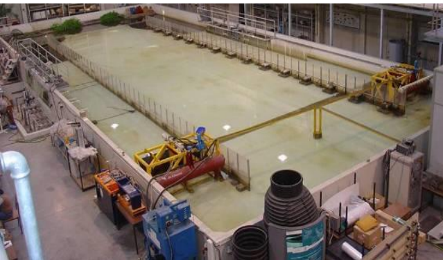
Figura 7. Novo tanque de ondas do laboratório de Hidráulica funcionando como dois “canais laterais” com os dois antigos batedores.
