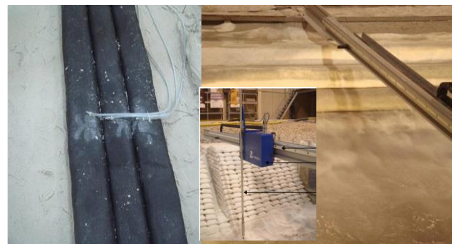
Figura 10. Ensaios em laboratório do comportamento de sistemas de confinamento de areias com geossintéticos. Dinâmica de fundos móveis na presença de geocontores e de geocilindros (FEUP).
