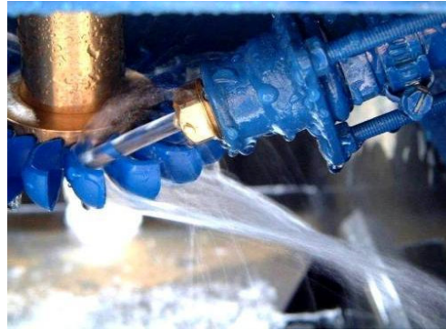
Figura 6.7 – Pormenor do jacto de água a incidir nas pás da turbina Turgo [40].
