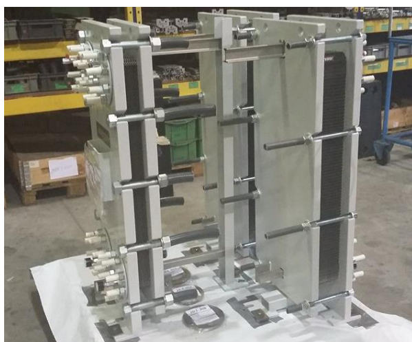
Figura 2.7 - Permutadores fabricados na Arsopi-Thermal
