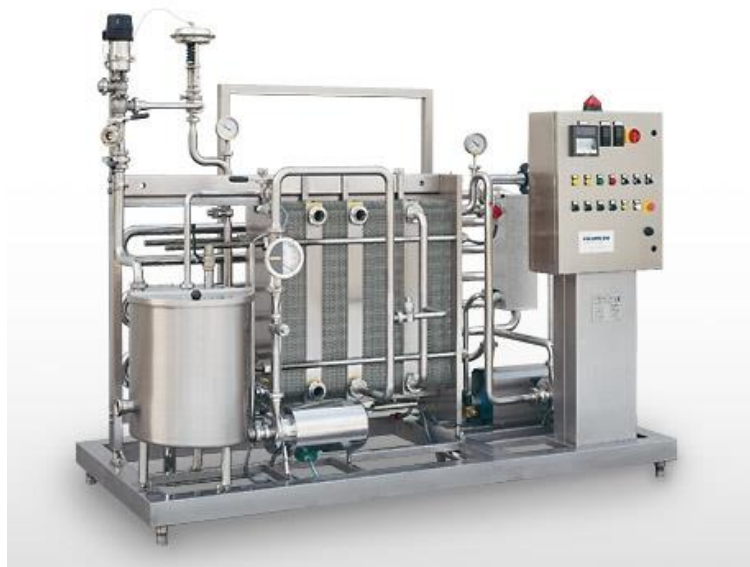
Figura 2.2 - Permutador de calor com múltiplas secções utilizado para pasteurização do leite [4]
