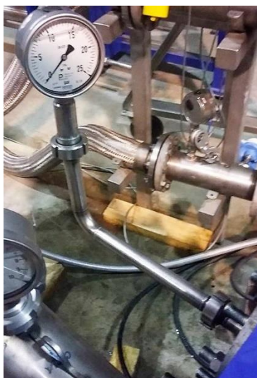
Figura 4.14 - Pressóstato para controlo da pressão no lado frio
