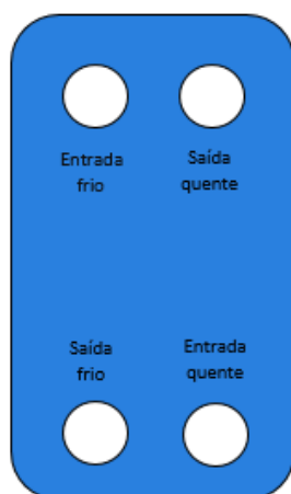
Figura 3.7 - Posição relativa dos orifícios de admissão e expulsão de os fluidos de trabalho para o permutador ASPTH e Omega
