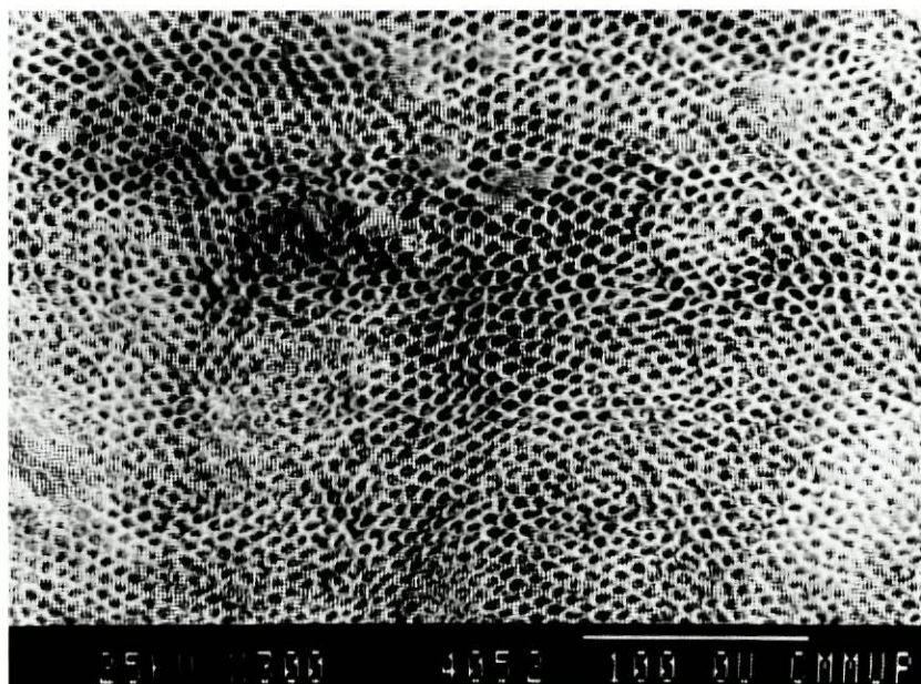
Fig. 27 — Padrão morfológico de ataque tipo central.
