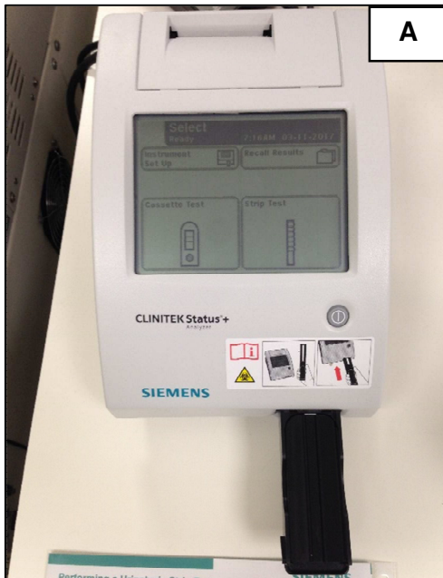
Figura 6 – Demonstração do material utilizado na análise da tira urinária: (A) Método de leitura automática através do equipamento CLINITEK Status Analyzer; (B) Método de leitura manual na escala disponível no rótulo da embalagem. (Imagem A gentilmente cedida pela Mestre Paula Brilhante Simões; Imagem B captada durante o período de estágio no Laboratório INNO).
