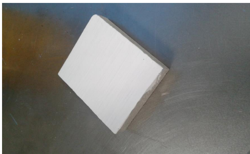
Figura 3 - Bloco seco, no qual não ocorreu qualquer ataque alcalino.
