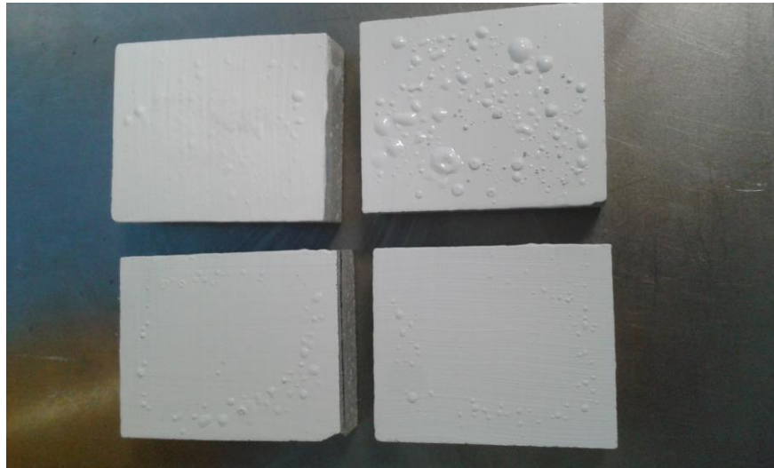
Figura 4 - Blocos relativos aos 4 ensaios que apresentaram empolamento.
