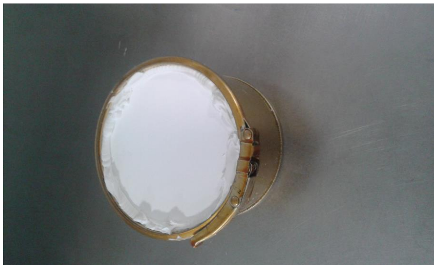
Figura 5 - Frasco utilizado na determinação da permeabilidade ao vapor de água, com o substrato revestido aplicado e selado com silicone.
