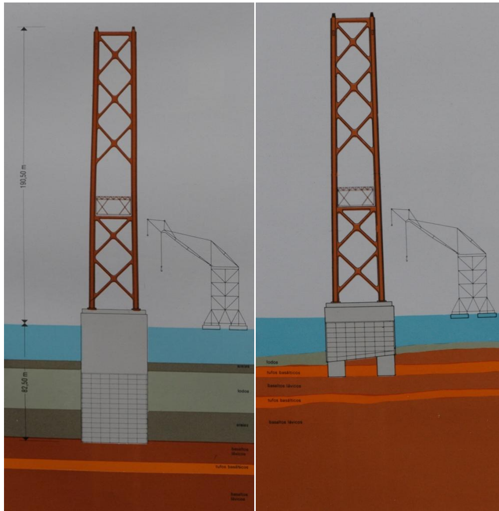
Fig. 2.26 – Fundação das torres da ponte 25 de Abril (retirado do livro Ponte Salazar , p. 78 e 79)
