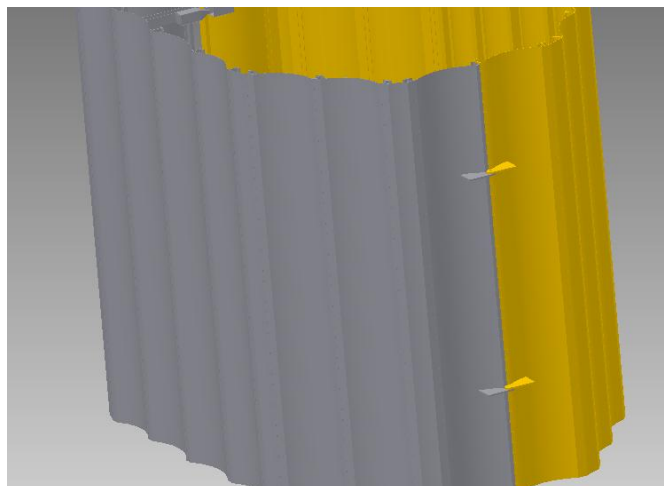
Fig. 3.11 – Modelação 3D das duas metades da ensecadeira unidas pelas norsas
