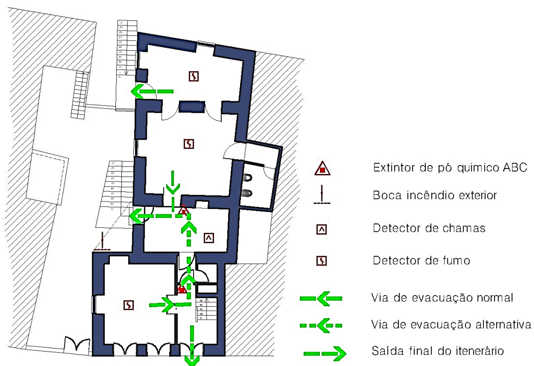
Fig. 7.1- Planta de emergência do 1º piso
