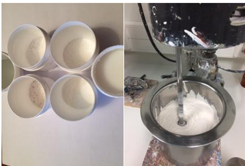
Figura 5. Exemplo de matérias primas utilizadas e do processo de fabrico da argamassa.
