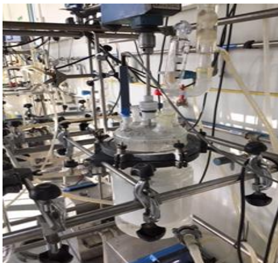
Figura 4. Reator para a polimerização dos monómeros em emulsão.
