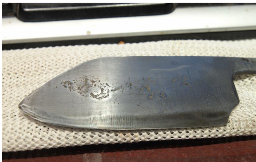
Figura 92 Defeito devido à presença de carepa na superfície de uma faca forjada (JZknives 2013)
