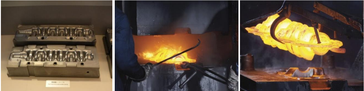
Figura 17 Matriz de forjamento de uma cambota e respetiva peça forjada, adaptado de (Whemco 2016).
