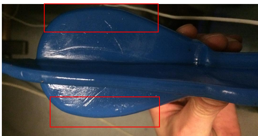
Figura 119 Defeito de falta de enchimento no encalcamento a 20mm.
