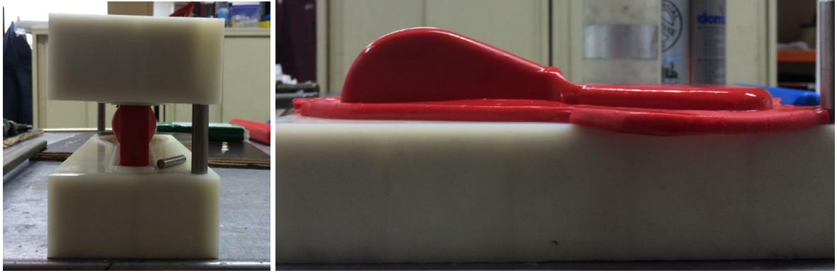
Figura 110 Simulação do encalcamento (em cima) e da matriz fechada (em baixo).
