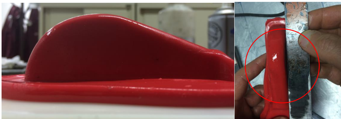
Figura 113 Defeito de falta de enchimento e deflexão da geometria.
