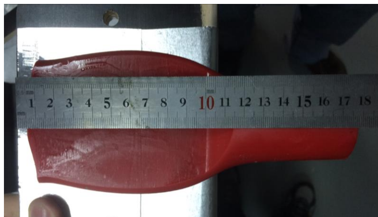
Figura 115 Comprimento obtido no encaimento a 18,5mm.
