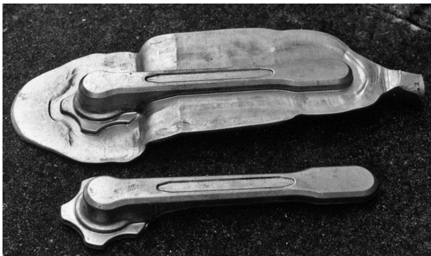
Figura 64 Exemplo da criação de rebarba (Forge 2015).
