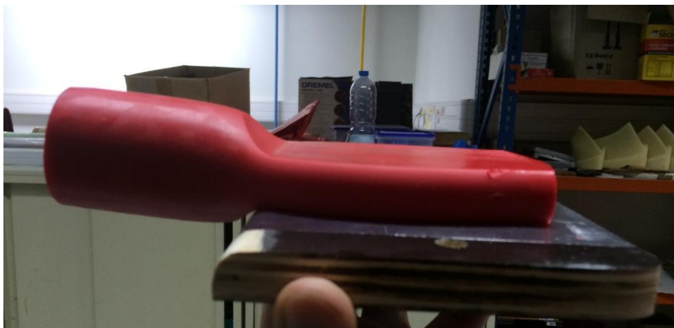
Figura 80 Exemplo de simulação de forjamento em matriz aberta em plasticina.
