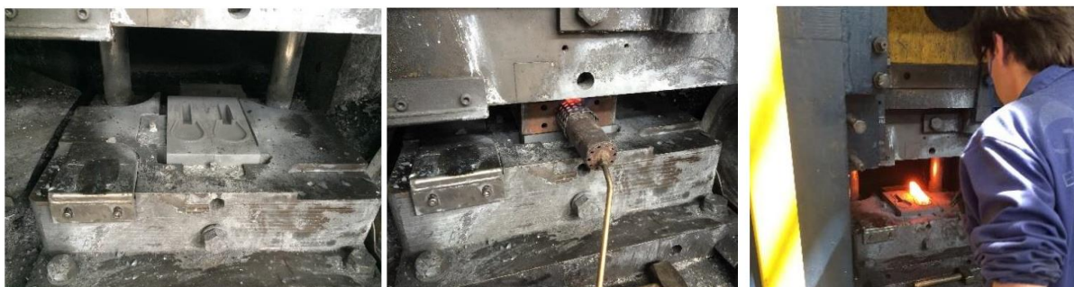
Figura 147 Diferentes fases do ensaio às ferramentas desenvolvidas, da esquerda para a direita: montagem e lubrificação das matrizes; pré-aquecimento controlado das matrizes fechadas até cerca de 200°C; colocação da 1ª pré-forma na segunda matriz.
