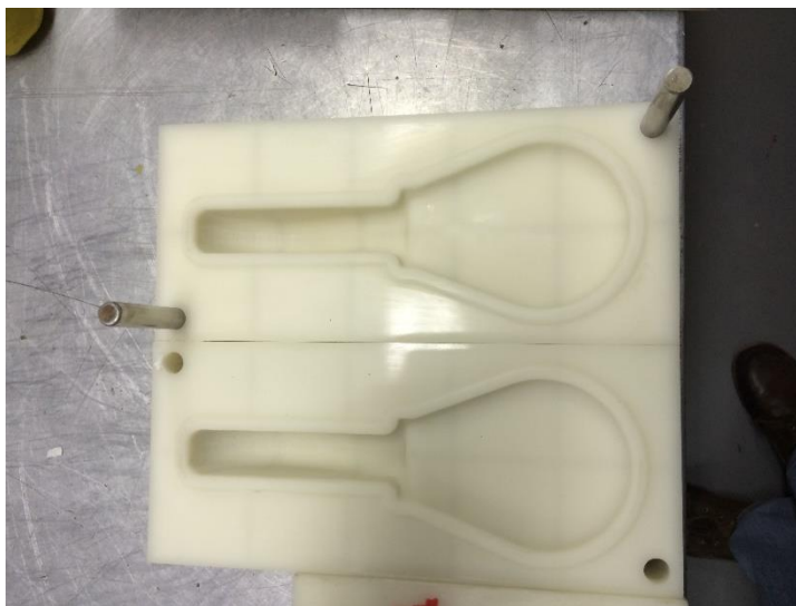
Figura 43 Matrizes de simulação do processo de forjamento fabricadas por prototipagem rápida.
