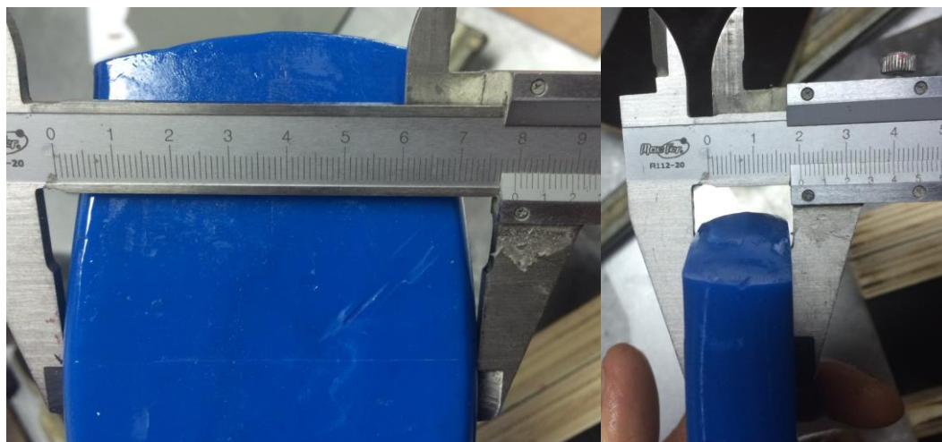
Figura 117 Largura obtida para um encalcamento a 20mm.
