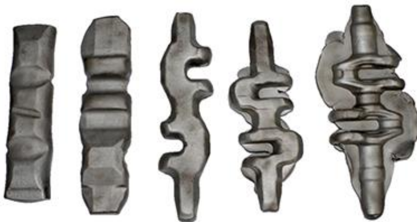
Figura 73 Diferentes etapas no processo de forjamento de uma cambota (REForCh 2014).
