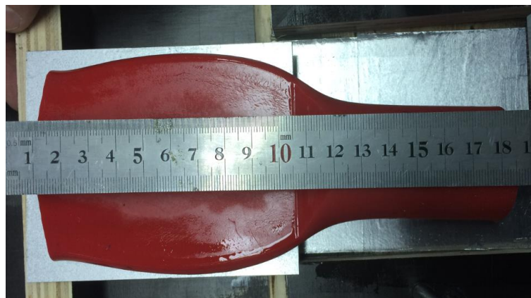
Figura 112 Comprimento obtido no encalcamento a 16,5mm.
