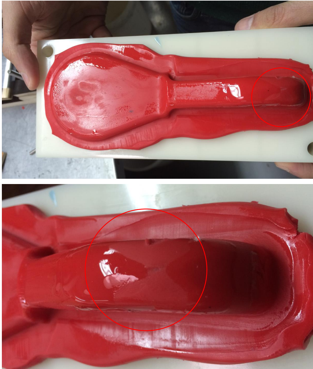
Figura 116 Defeito de falta de enchimento no encaimento a 18,5mm.
