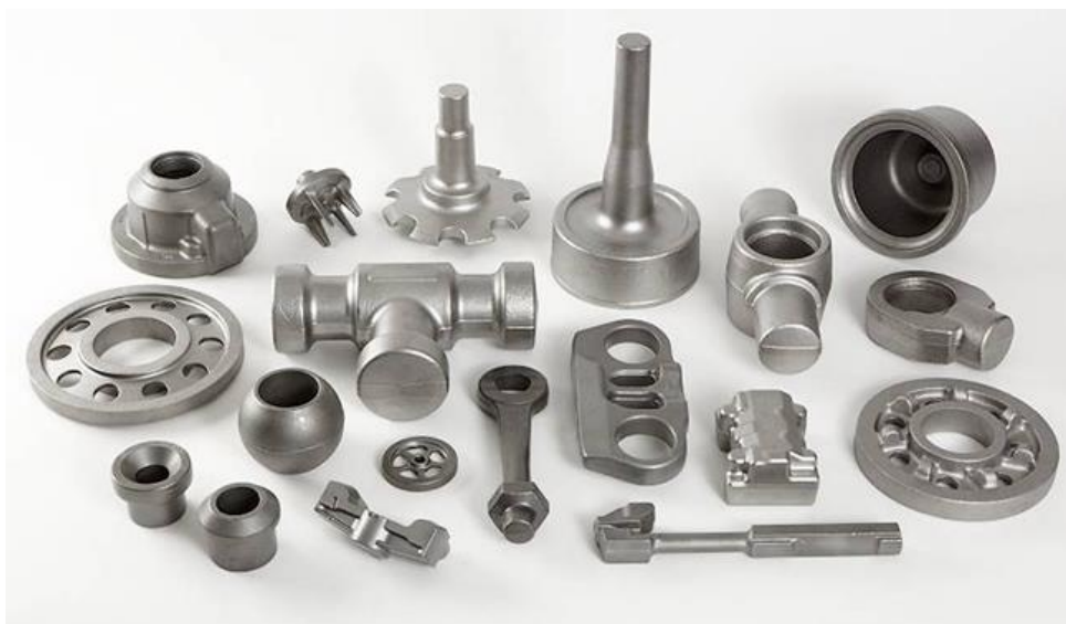
Figura 10 Exemplos de algumas peças forjadas (Forge 2016b).
