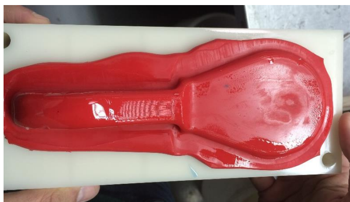
Figura 45 Simulação do processo de forjamento em plasticina.
