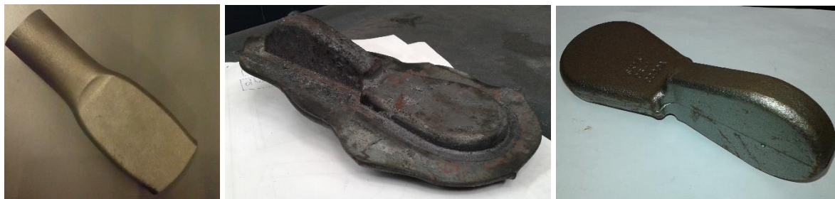
Figura 148 Da esquerda para a direita: 1ª pré-forma; 2ª pré-forma com rebarba; forma final sem rebarba.
