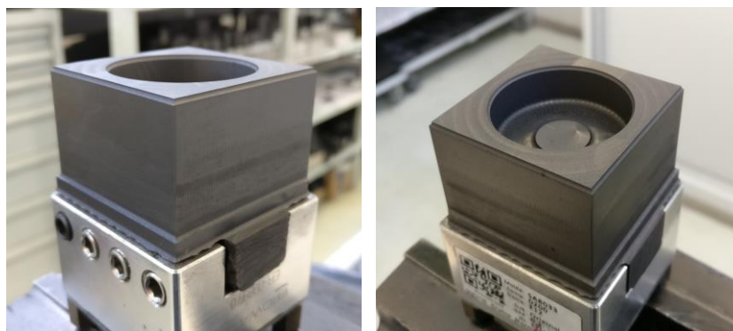
Figura 36 - Eléctrodo maquinado utilizando a função de compensação de raio de ferramenta.
