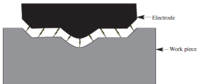
Figura 3 - Ilustração de eletroerosão por penetração ou convencional [7].
