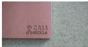
Figura 50. Pormenor do corte feito a laser
