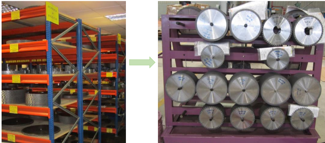
Figura 38- Estrutura de armazenamento das serras.
