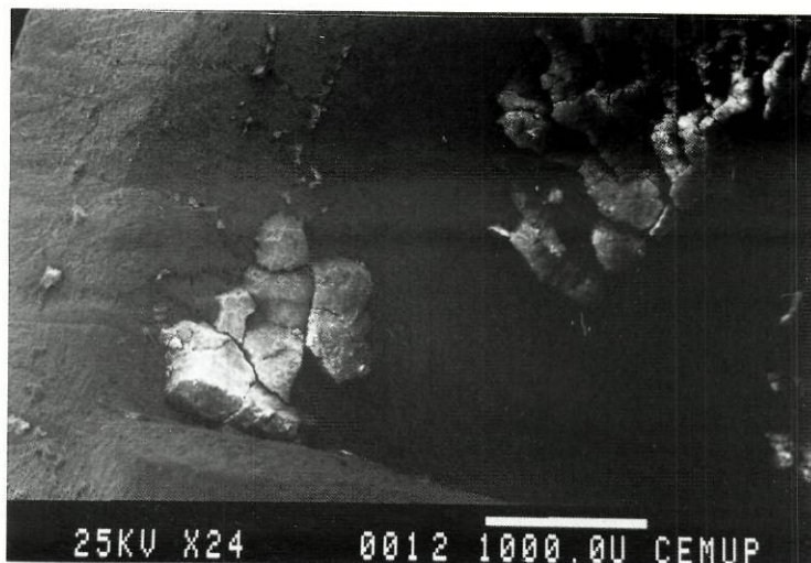
Fig.: 28 - Aspecto microscópico de fragmentos de cimento de ionómero de vidro no interior da coroa com o tratamento electroquímico (24X)
