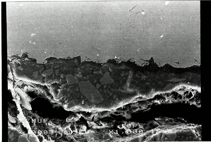
Fig.: 41 - Aspecto microscópico da interface cimento de ionómero de vidro/metal com o tratamento com óxido de alumínio (1000X)
