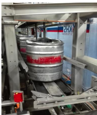
Figura 7 - Estações de um módulo de enchimento
