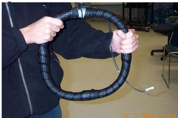
Figura 2.2 - Volante pneumática desenvolvido pela Universidade de British Columbia [17]
