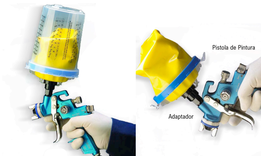
Figura 11 – Utilização do kit NPS (Adaptado de: Saint-Gobain Abrasives )
