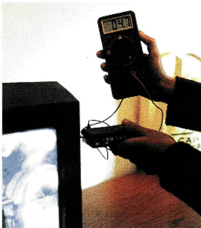
Figura 6.15 Electrómetro colocado ao lado do televisor.
