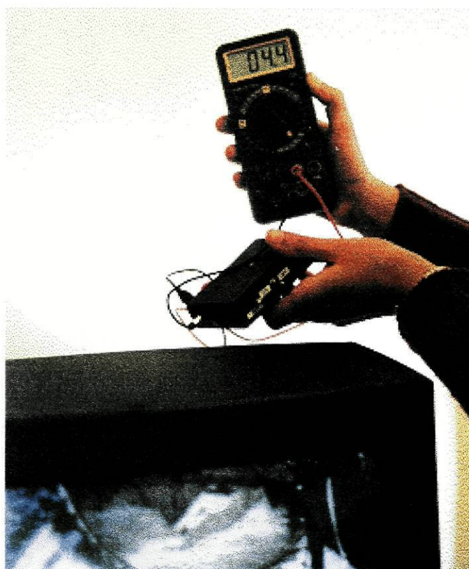
Figura 6.16 Electrómetro colocado por cima do televisor.
