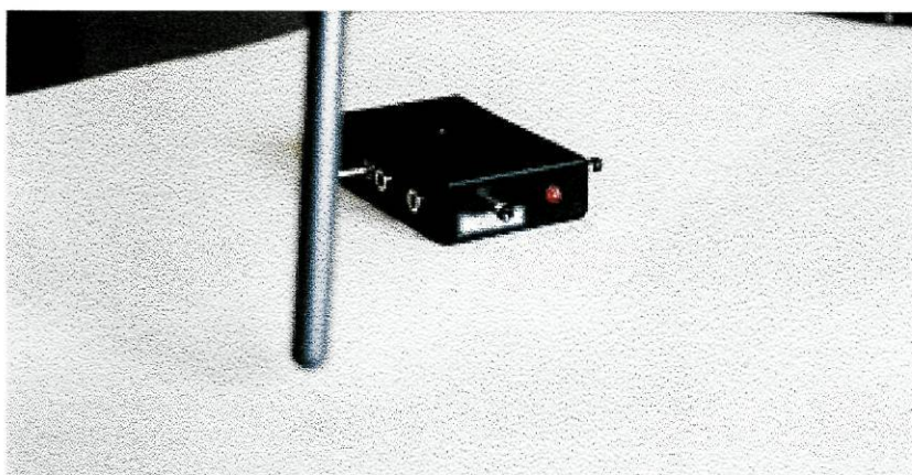
Figura 6.9 Afastamento de uma barra de plástico carregada negativamente: o LED acende.
